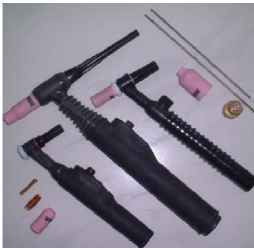
Fig.10.2. Pistolet de sudare WIG
