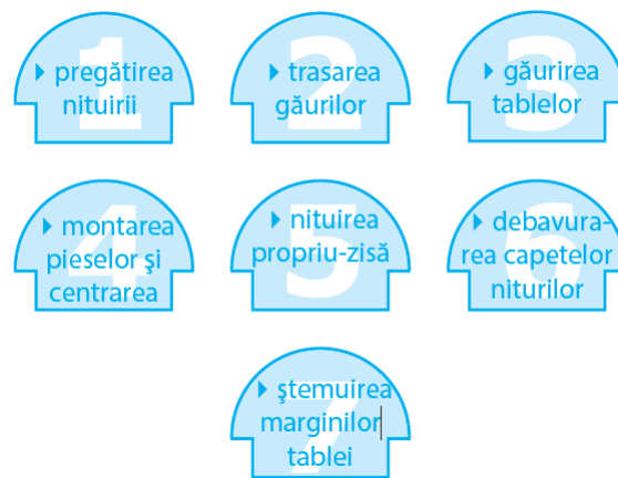
Fig.5.2. Fazele nituirii manuale
